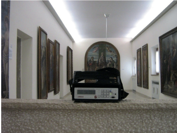
Figura 7. Quantificazione del Particellato Sospeso Totale (PST) e delle polveri sottili (PM10) mediante spettrometro portatile
