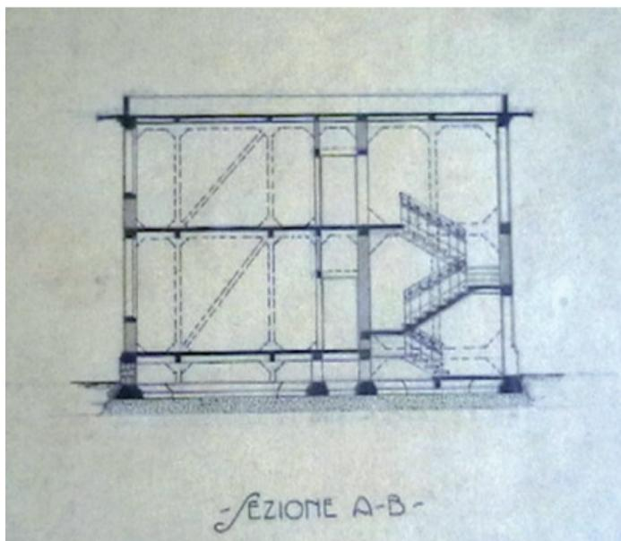
Figure 5. Attilio Muggia, *Prog. n. 1883, Villino antisismico con ossatura in cemento armato, 1916, India ink on paper. (Archivio Storico dell'Ordine degli Architetti di Bologna – cart. 3/23, H XXIX, D V bis)*
