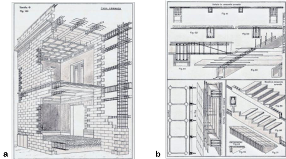
Figure 8. Gino Zani, Tavola 6 – Casa asismica; Tavola 4 - Solai, Soffitti e Scale. (LO CURZIO 1986)
