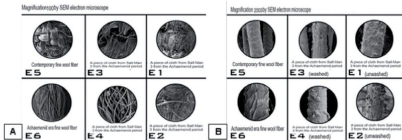
Figura 8. Fibre di lana dei campioni E1-E6. A) Ingrandimento 100 x e B) 2000x by SEM. Campioni di controllo E6 e E5; nel caso dei campioni E4, E2, E3, E1 cristalli di sale e danneggiamenti sono chiaramente visibili.
