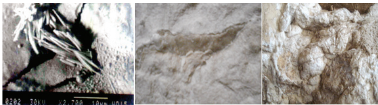
Figura 2. (b) forma dell'ago di salgemma nella stanza massimale, Tomba di Oserkon II, Tanis; (c) vene di salgemma all'interno dei blocchi di pietra calcarea, camera di sepoltura del re Oserkon II; (d) scioglimento e precipitazione di calcite, tomba del re Oserkon II
