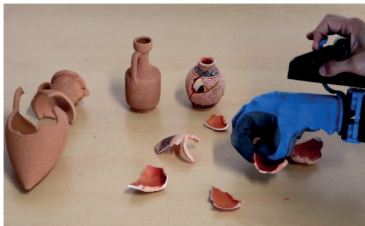
Figura 1. Progetto "RePAIR". Ricostruzione fisica di opere d'arte frammentate mediante restauro manuale o assistito da computer, riferita allo sviluppo di un sistema robotico intelligente in grado di elaborare, riconoscere e assemblare autonomamente grandi manufatti fratturati.
