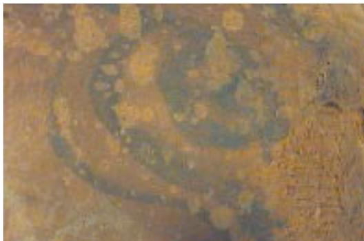
*Figura 6. Alterazioni cromatiche ed abrasione della carta (videomicroscopio 10X).*
